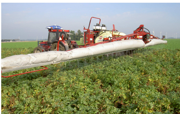
Traktor se snímačem na kabině měří biomasu a postřiková dávka je následně přizpůsobena zjištěným rozdílům v porostu.
